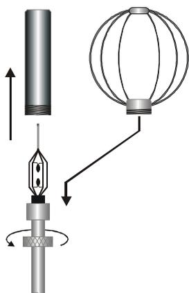
La sonda **AP3203** è dotata di uno schermo di protezione sferico. Per ridurre l'ingombro quando non viene utilizzata, la sonda **AP3203** viene fornita con un cilindro di protezione da avvitare sulla testa della sonda.
