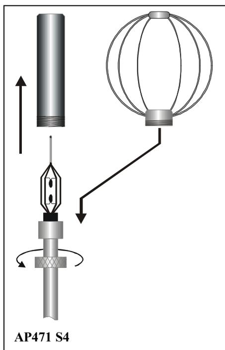
Le sonde AP471 S1, S2 ed S3 sono dotate di uno schermo cilindrico di protezione in grado di scorrere longitudinalmente su una guida. Lo schermo ha due posizioni di fine corsa che lo bloccano nella condizione di misura (tutto in basso) oppure di riposo (tutto in alto). Per ridurre l'ingombro quando non viene utilizzata, la AP471 S4 e la AP471 S5 vengono fornite con un cilindro di protezione da avvitare sulla testa della sonda.
