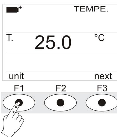
Premendo il **tasto funzione F3** quando sull’ultima riga del display è presente la scritta **next** si passa alla visualizzazione delle misure rilevate dalla **sonda combinata di umidità-temperatura** completa di modulo SICRAM, con la seguente visualizzazione:
