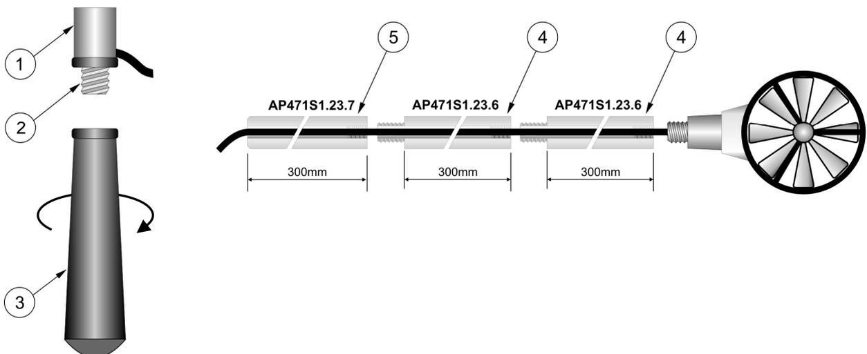
Le sonde **AP472 S1** - **AP472 S2** oltre all'asta di estensione telescopica con la testa orientabile possono impiegare l'asta prolunga rigida  $\varnothing 16\text{mm}$ . Per svitare l'impugnatura (3) tenere fermo il corpo della sonda nel punto (1). Avvitare la sommità dell'asta **AP471S1.23.6** (4) sulla vite (2). E' possibile aggiungere altre aste di estensione **AP471S1.23.6**. L'ultimo elemento può essere l'impugnatura (3) o l'asta di estensione **AP471S1.23.7** (5).
