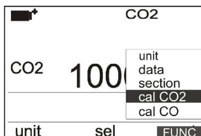
5. Erogare per almeno 2 minuti CO<sub>2</sub> in modo che la misura si stabilizzi.
