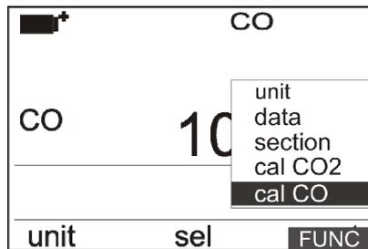
7. Appare la schermata per l'operazione da eseguire sul sensore (calibrazione o sostituzione):
