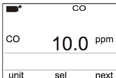
La prima riga del display riporta la sigla “CO”, indicando che a display è visualizzata la misura della **concentrazione di monossido di carbonio** rilevata dalla **sonda di CO** con modulo SICRAM.
