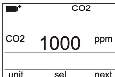
La prima riga del display riporta la sigla “CO<sub>2</sub>”, indicando che a display è visualizzata la misura della **concentrazione di biossido di carbonio** rilevata dalla **sonda di CO<sub>2</sub>** con modulo SICRAM.
