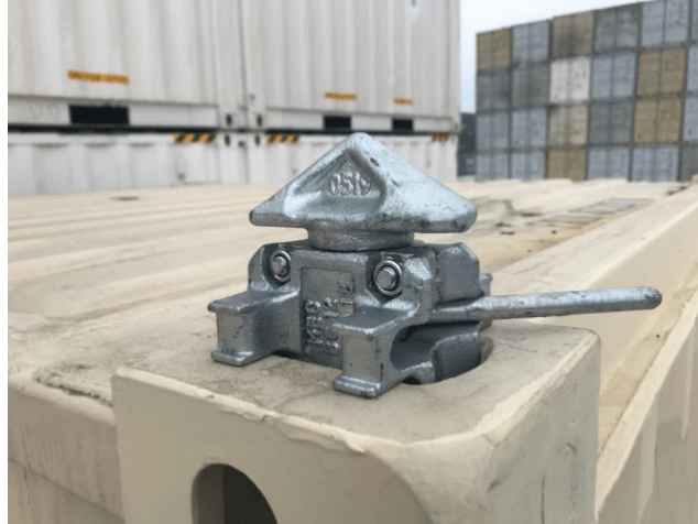
Immagine 3: Twist Lock situato su un contenitore
