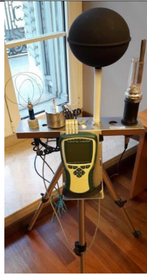
Figura 8: centralina microclimatica con strumento di ricezione dati ALMEMO 2690-8
