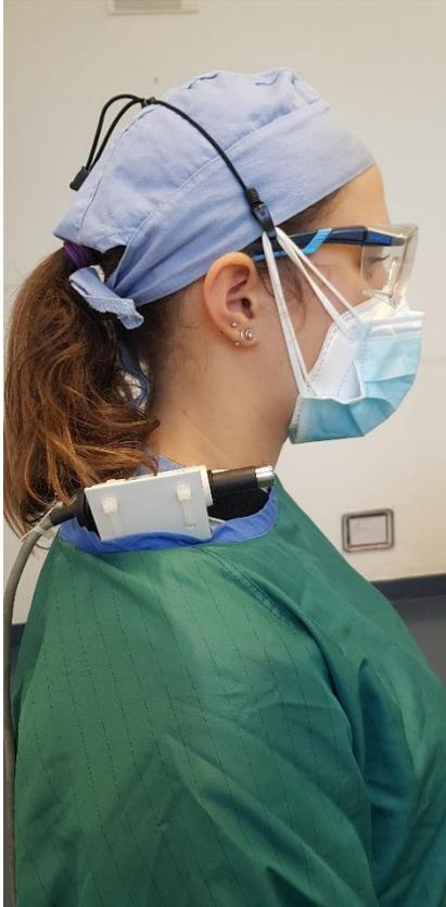
**Figura 8** – Misure personali: posizione del microfono sulla spalla dell'operatore con il supporto
