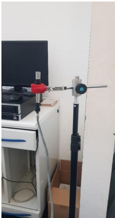
*Figura 6 – Misure ambientali di fondo: posizione microfono*
