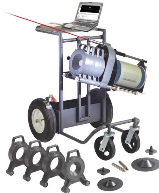
Fig. 6.3: Rivelatore AEGIS nella configurazione utilizzata durante le acquisizioni [15]
