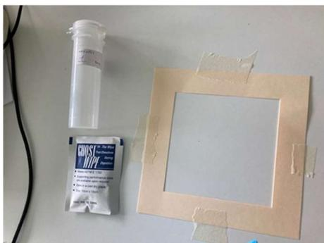
Fig.14: Materiale utilizzato per il campionamento: Ghost Wipe, sagoma di carta con dimensioni 10x10cm e provetta correttamente etichettata con data del prelievo e identificazione del punto di campionamento.
