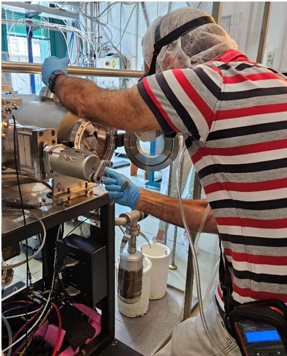
Fig.12: Apertura del Load Lock per il prelievo dei campioni
