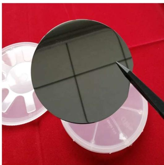
Fig.1: Wafer di Arseniuro di Gallio (GaAs)
