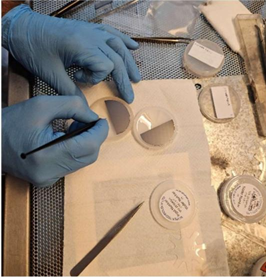
Fig.10: Taglio del campione con punta diamantata
