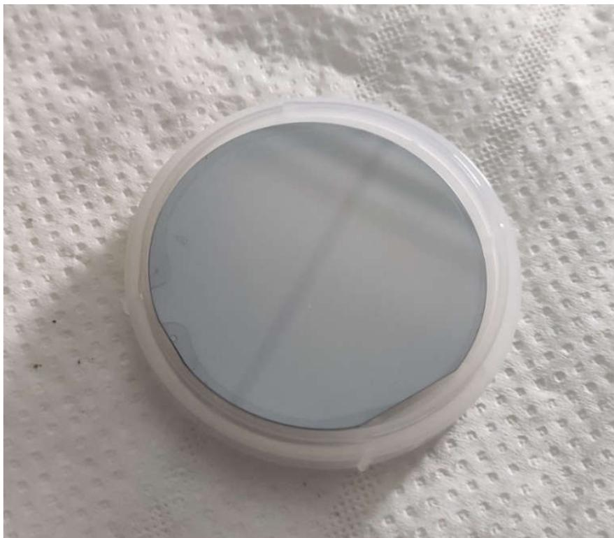
*Fig. 2.3 Esempio di wafer di GaAs*
