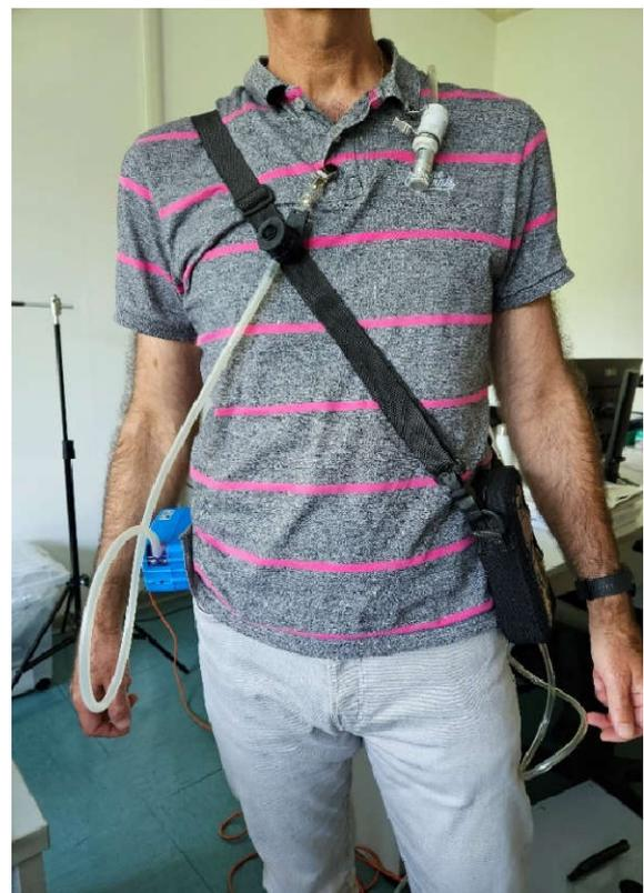
*Fig 4.9: Dispositivi indossati: DiSCmini (destra in foto) e pompa con campionatore IOM (sinistra in foto)*
