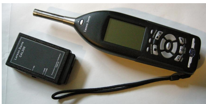
Figura 2 : Fonometro Larson Davis 824 e calibratore acustico CAL200
