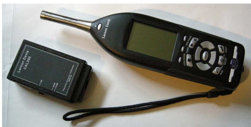
Figura 5: Fonometro Larson Davis 824 e calibratore acustico CAL200
