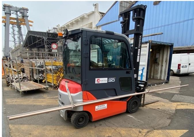
Figura 10 - Carrello elevatore frontale utilizzato in maniera non idonea
