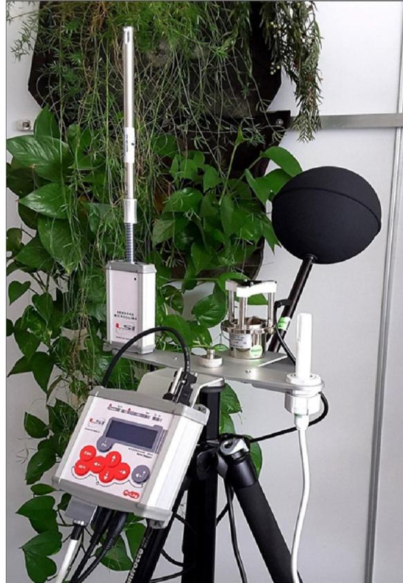
Figura 10: Centralina Microclimatica LSi Lastem composta dal Data-logger M-Log e le quattro sonde per la misurazione dei parametri del WBGT
