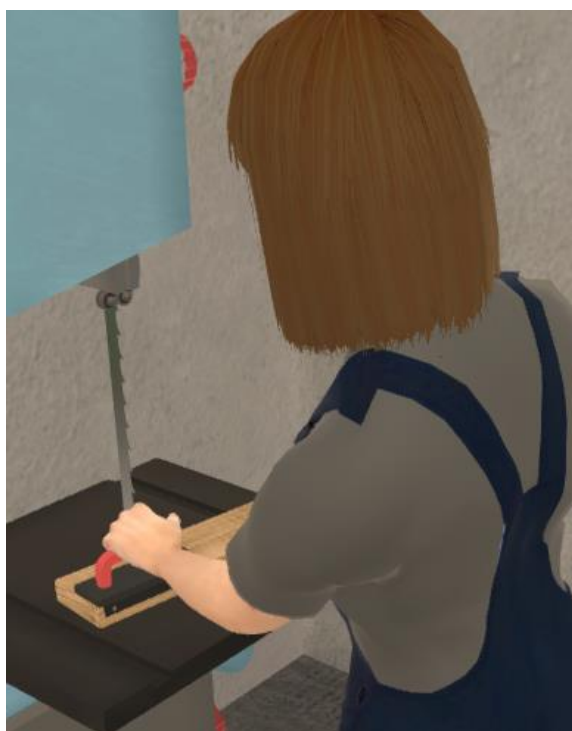
Figura 7: sega a nastro da banco senza protezione
