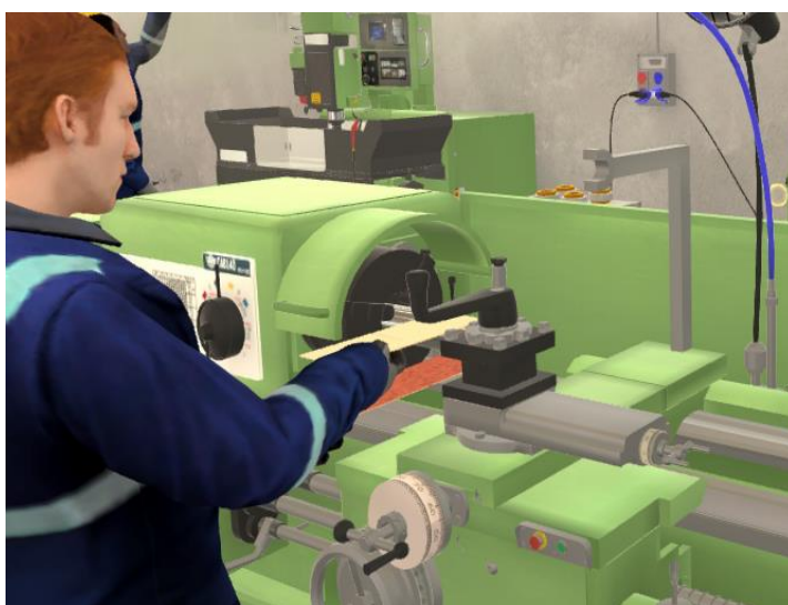
Figura 9: tornio usato in maniera impropria
