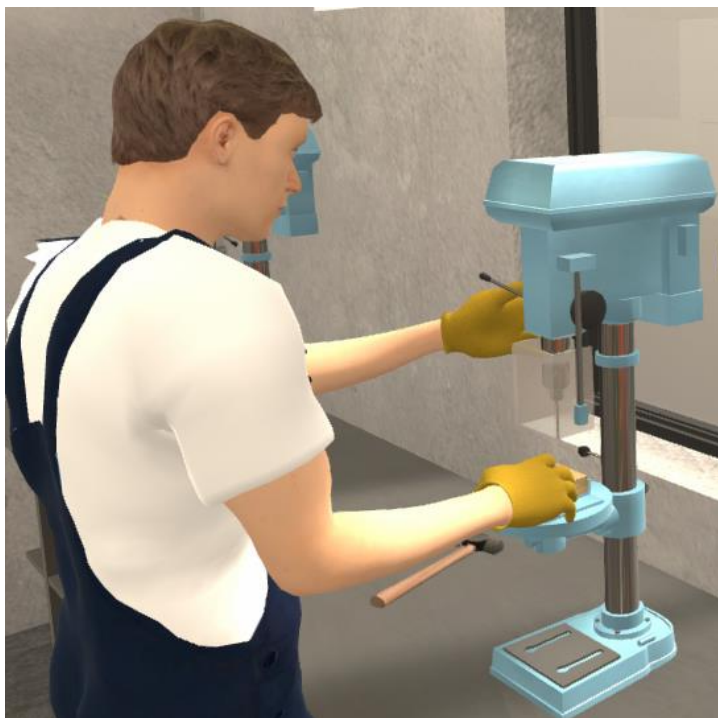
Figura 1: trapano a colonna con utilizzo dei guanti
