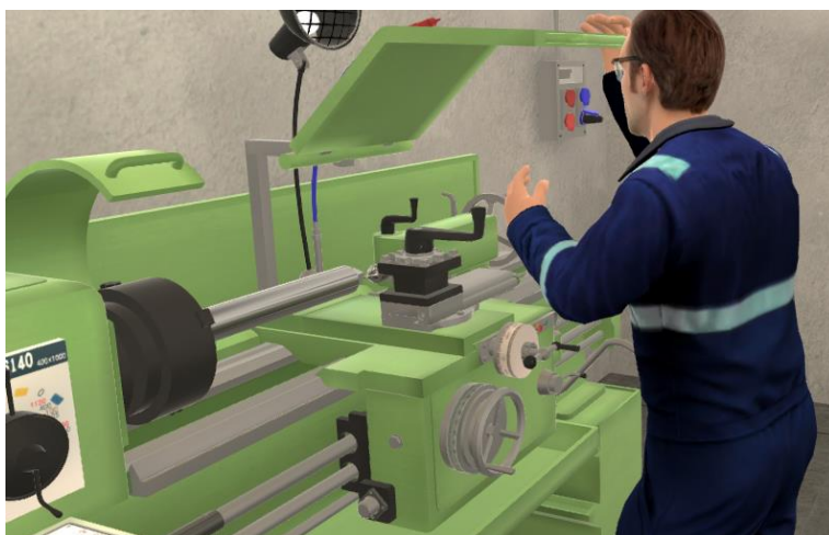
Figura 11: tornio con protezioni alzate
