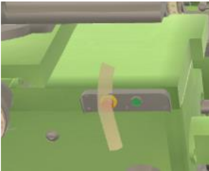
Figura 10: elusione del pulsante di emergenza
