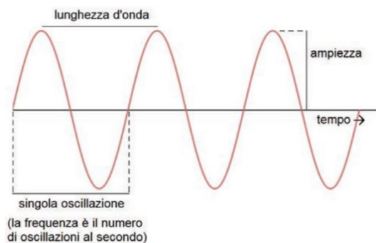
Figura 5 Parametri descrittivi dell'oscillazione meccanica che produce la vibrazioni
