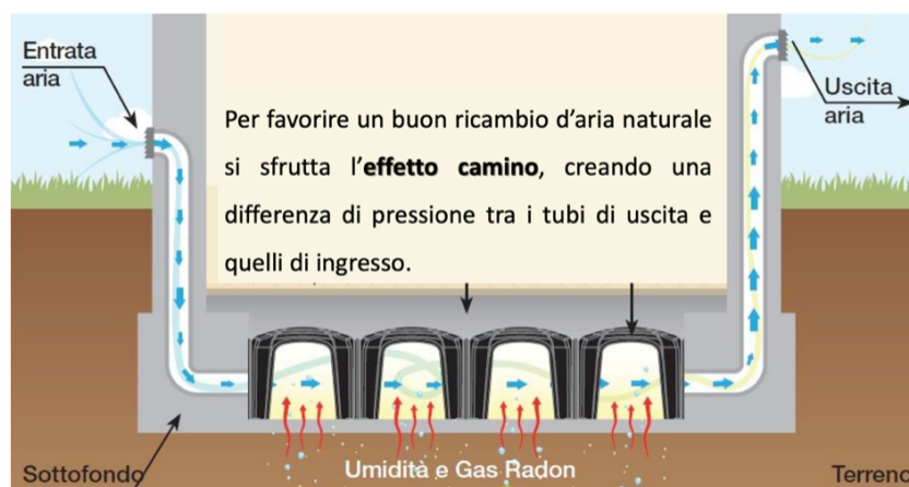
Figura 2: Sistema drenante sottosuolo
