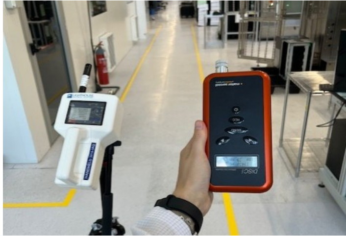
Figura 6: DiSCMini Testo e Lighthouse Handheld 3016 IAQ Airborne Particle Counter (da destra verso sinistra)
