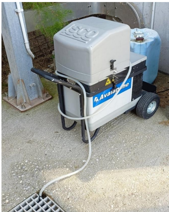
Figura 4: Campionatore automatico programmabile per liquidi in fase di prelievo.
