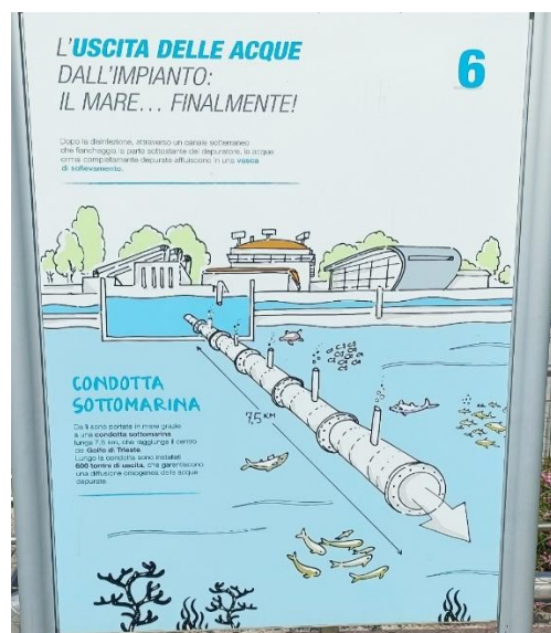
Figura 3: Illustrazione della condotta sottomarina che diffonde i reflui depurati in uscita dall'impianto in mare aperto.
